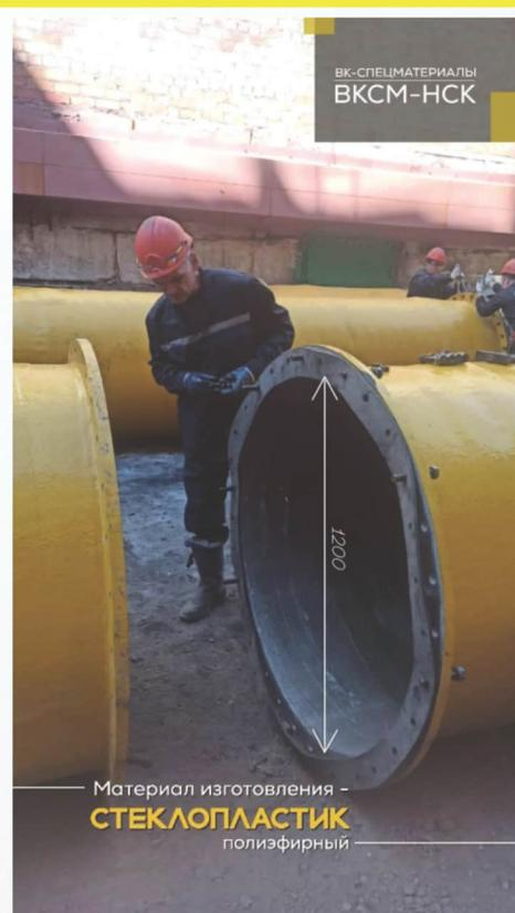
Стеклопластиковые трубопроводы и соединительные детали к ним (фитинги), изготавливаются в соответствии с ГОСТ Р 54560-2011 и СТ РК 1128-2002 и на основе полиэфирных смол методом намотки пропитанного связующим стекловолокна на оправку с последующим отверждением в едином технологическом процессе и методом ручного формования.
